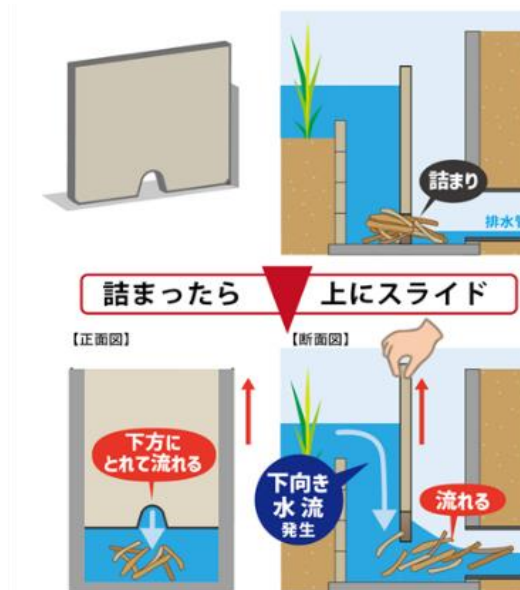
図-2 下方開放式調整板のゴミ除去作業
